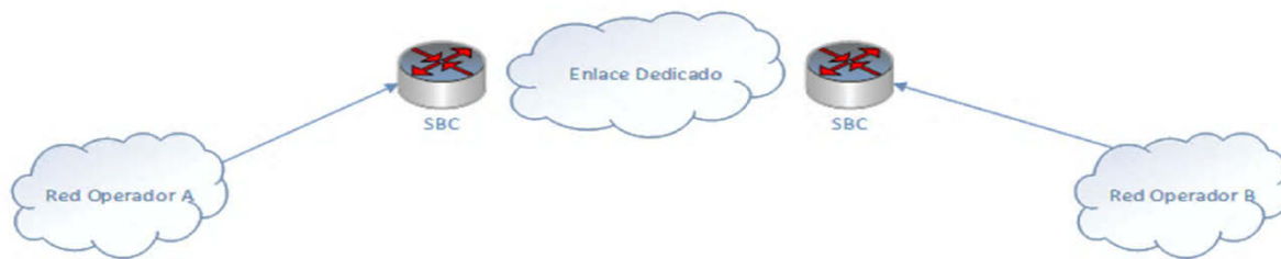
Figura 1. Topología de interconexión SBC-SBC
