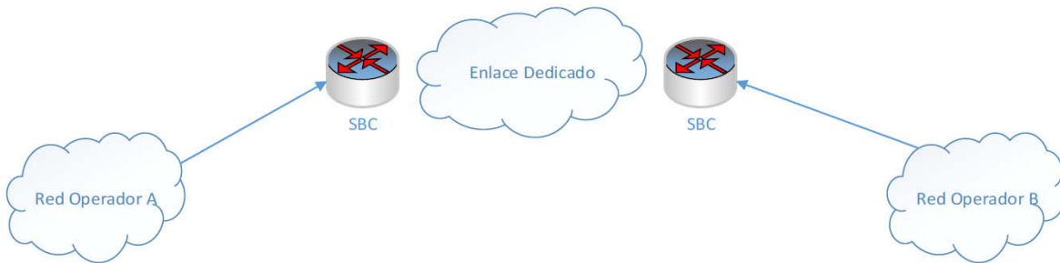
Figura 1. Topología de interconexión SBC-SBC
