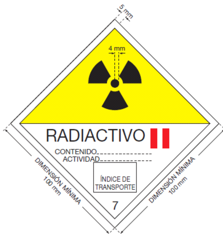
Figura A.3 Etiqueta para la categoría II-AMARILLA. El color de fondo de la mitad superior de la etiqueta será amarilla y el de la mitad inferior blanco, el trébol y los caracteres y líneas impresos serán negros y las barras que indican la categoría serán rojas.
