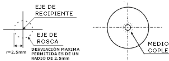
CONCENTRICIDAD DEL EJE DE LA ROSCA
