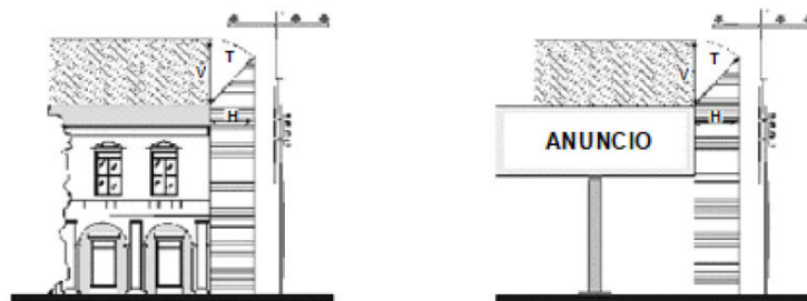
Figura 4 - Transición entre separaciones horizontales y verticales
