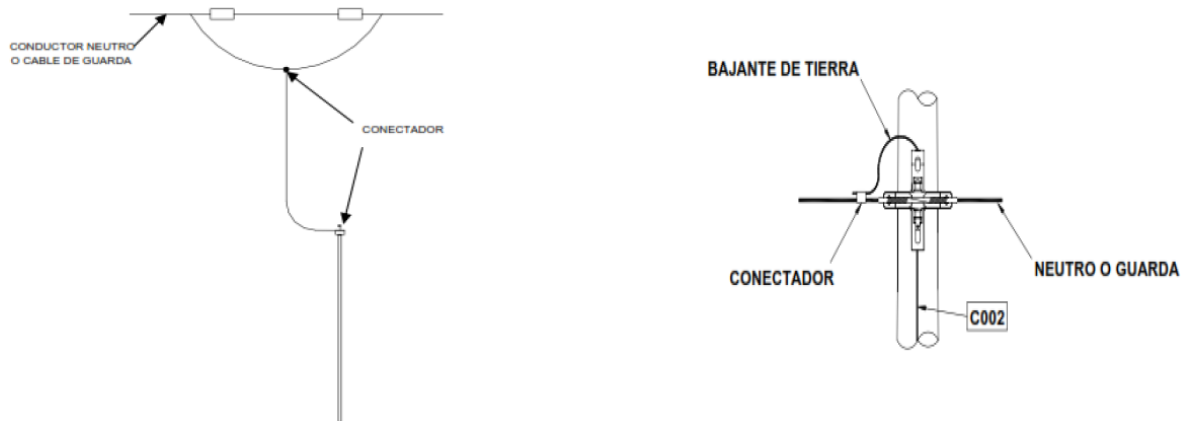
Figura 16 - Conexión de cable de neutro corrido con cable de guarda.
