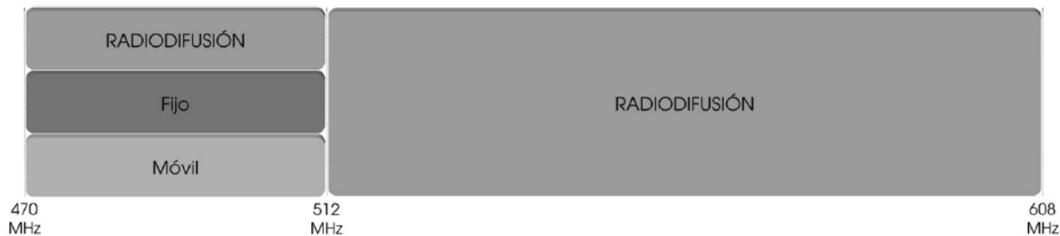
Figura 1. Representación gráfica de las atribuciones para la Región 2 del RR de la UIT-R
